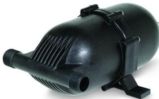
Le réservoir sur presseur SHURFLO est destiné à retenir l'eau sous pression. Il assure un stockage d'eau tampon et prolonge la durée de vie des pompes avec contacteur manométrique en diminuant le cycle marche/arrêt de la pompe.
