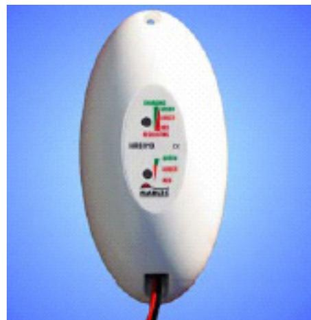
Le limiteur de charge HRS503 est à utiliser avec l'aérogénérateur Rutland 503/504 associés à des panneaux solaires de puissance crête maximum de 100Wc. Il comprend une diode antiretour intégrée qui permet d'utiliser des sources de charges additionnelles.
